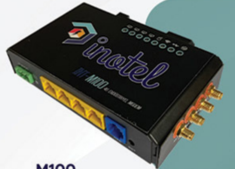
M100 Endüstriyel Modem 4 Adet LAN, 1 Adet WAN Portu 2G / 3G/ 4G Hücresel Haberleşme APN & VPN Desteği Wi-Fi
