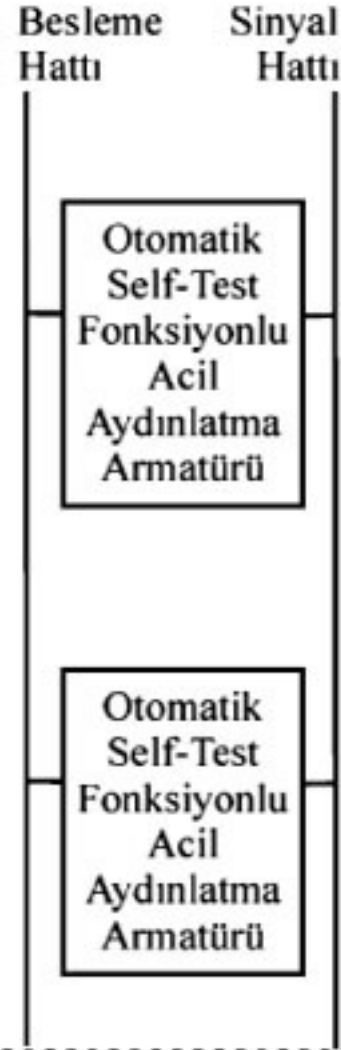
Şekil 7: Alışveriş bir Sistemde Acil Aydınlatma Armatürlerinin Bağlantısı
