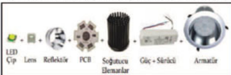
Şekil 2 Örnek aydınlatma sistem elemanları [4]
